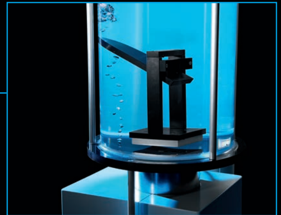
Burbujas de aire ascendentes demuestran el funcionamiento de la tecnología de pesada con SupraSensor: cuanto mayor es la fuerza ascendente, tanto más bajo es el peso específico del cuerpo magnético.
