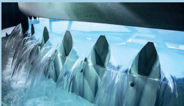
El equipo de descarbonización rápida reduce la dureza del agua subterránea en 10 puntos según la escala de dureza alemana, quitándole así su «agresividad».
