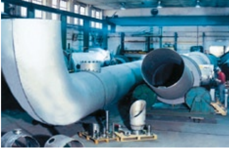
Los tubos con soldadura de cordón longitudinal, fabricados con dos semipiezas, ofrecen ventajas en relación con la técnica de corriente.
