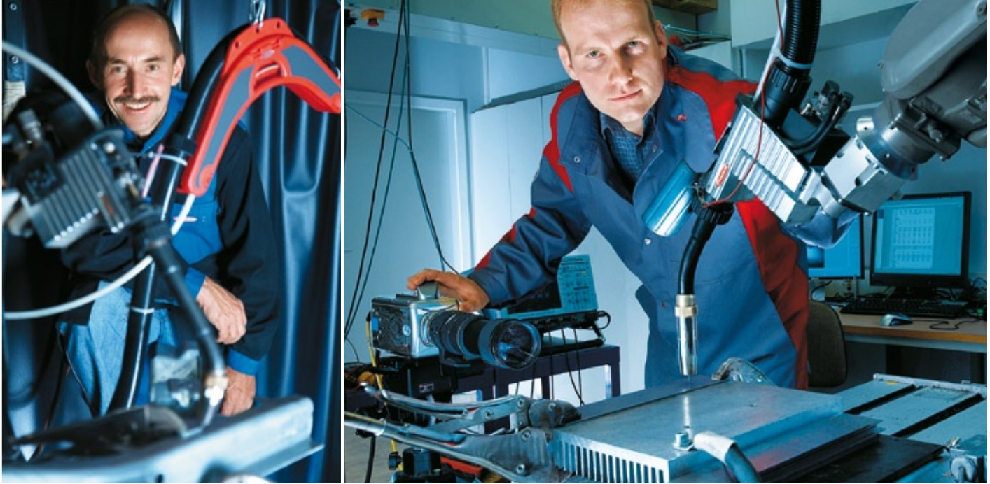
Visiones como punto de salida para nuevas técnicas de ensamblaje. Un resultado: CMT permite unir los materiales acero y aluminio que hasta hace poco no se podían soldar.
