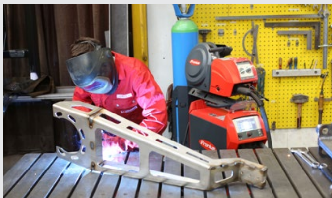
Soldadura del soporte de pantalla de acero inoxidable
